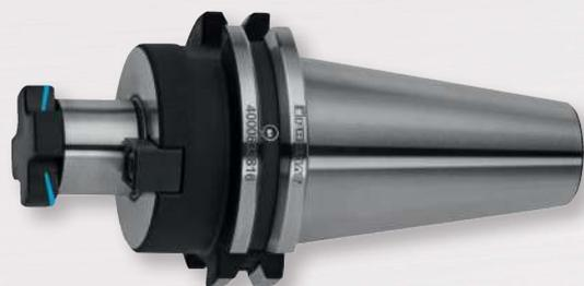
**PROMAT****Quernutaufsteckfräsdorn**mit vergrößertem Bunddurchmesser · mit Steilkegel nach DIN 69871 Form AD/B · mit zentraler Kühlmittelzufuhr und wiedererschließbaren Kühlkanälen am Bund sowie mit **zusätzlichen Kühlkanalbohrungen an der Stirnseite** · zur Aufnahme von Messerköpfen und Fräsern mit Quernut DIN 1880 · Spann-Ø 40 mm zusätzlich mit 4 Gewindebohrungen nach DIN 2079
