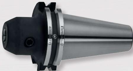
**PROMAT****Flächenspannfutter****(Weldon) · mit Steilkegel DIN 69871 Form**AD · zur Aufnahme von Werkzeugen mit Zylinderschaft und seitlicher Mitnahmefläche nach **DIN 1835-B · Bohrungstoleranz H4**
