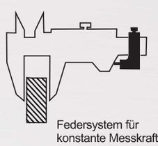
Federsystem für konstante Messkraft
